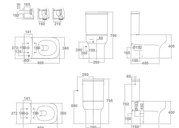
**Nota:** \*El conjunto inodoro completo está formado por: inodoro para tanque bajo BTW rimless, tanque completo de 4/2 litros y asiento fijo. BTW: Pegado a la pared. \*\*El conjunto inodoro completo está formado por: inodoro para tanque bajo BTW, tanque completo 4,5/3L y asiento fijo.
